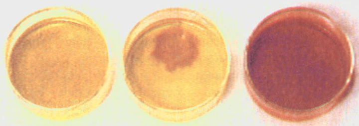
ΣΧΗΜΑ 4.1 Προσθήκη οξέος σε διάλυμα \text{CrO}_4^{2-} οδηγεί τελικά στην επικράτηση του πορτοκαλοκόκκινου χρώματος, που είναι το χρώμα των \text{Cr}_2\text{O}_7^{2-}
