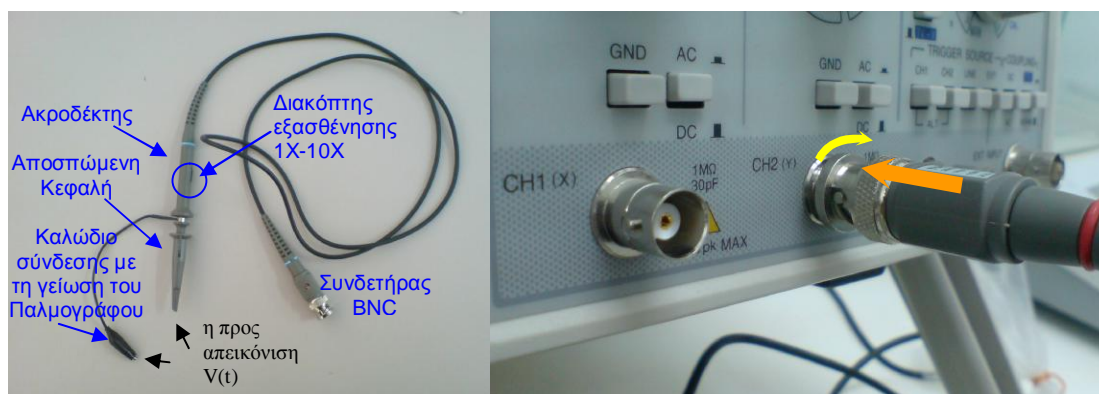
Σχήμα 2. Καλώδιο εισόδου και Συνδετήρας BNC. Δεξιά δείχνονται τα βήματα της σύνδεσης.
